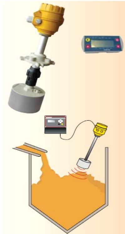
شکل (2-96): اندازه‌گیری سطح بروش آلتراسونیک
