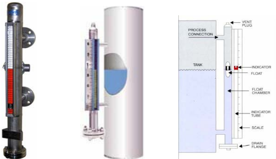
شکل (2-77): اندازه‌گیر لول از نوع شناوری
