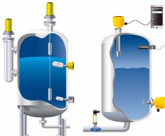
شکل (2-81): محل نصب اندازه گیر لول و سوئیچ از نوع شناوری
