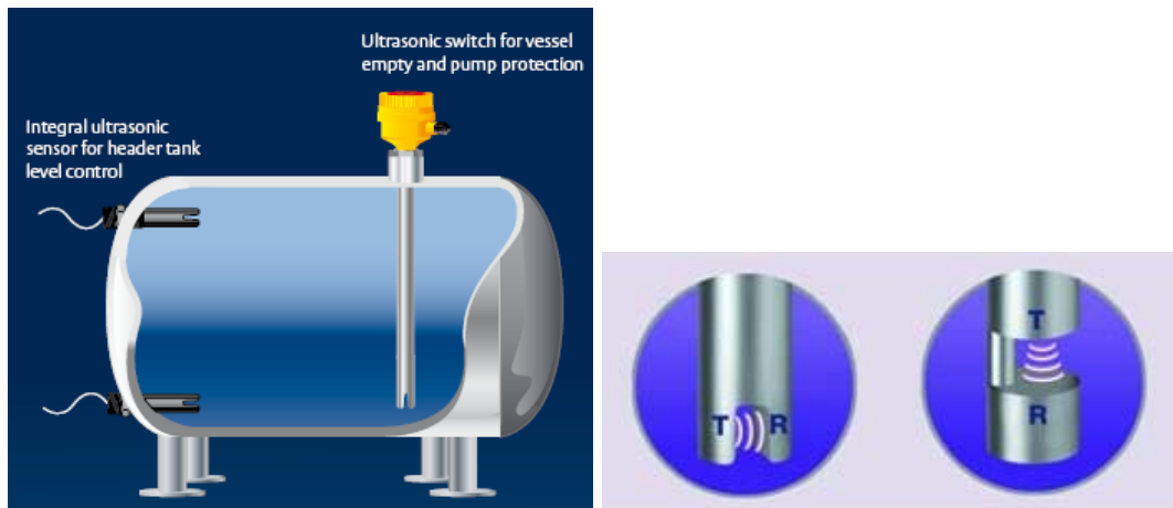
شکل (2-98) اساس کار و محل نصب سوئیچ آلتراسونیک
