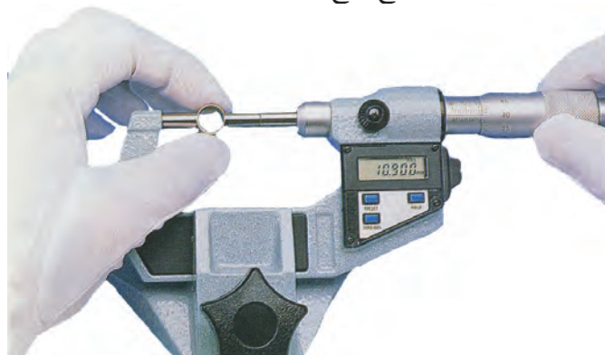
شکل ۳۱-۵ اندازه‌گیری به وسیله میکرومتر دیجیتالی
