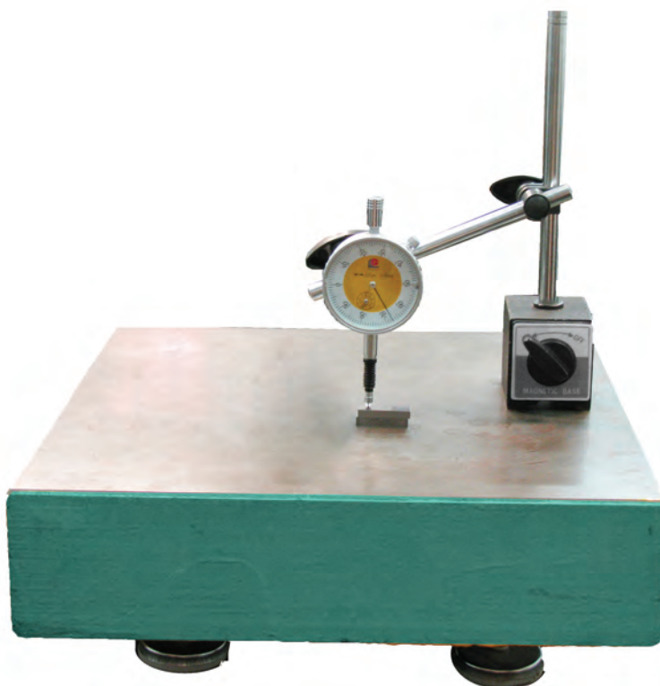
شکل ۲۱-۶- آماده‌سازی ساعت برای عملیات کنترل
