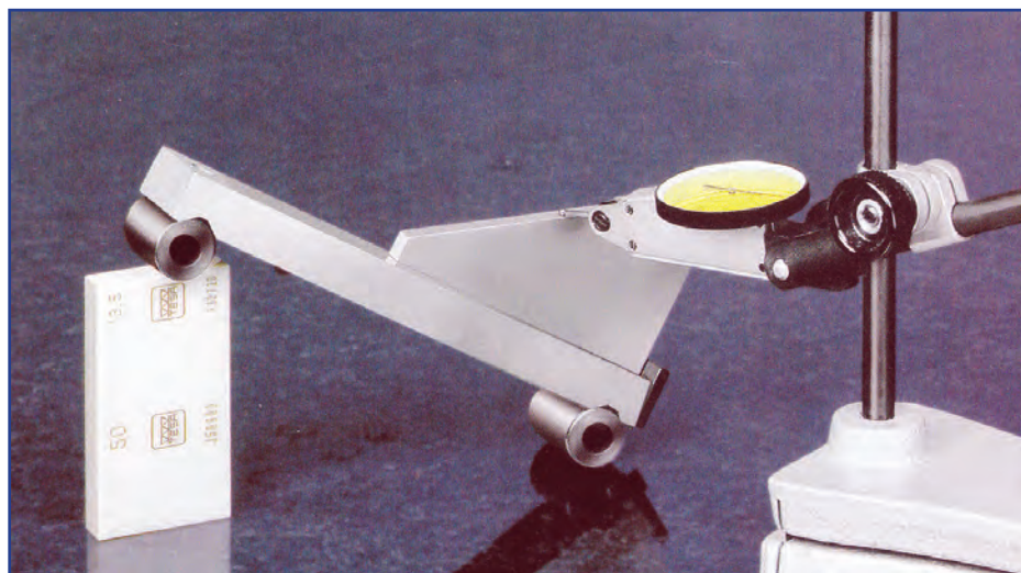
شکل ۱۶-۷ اندازه‌گیری زاویه به کمک خطکش سینوسی
