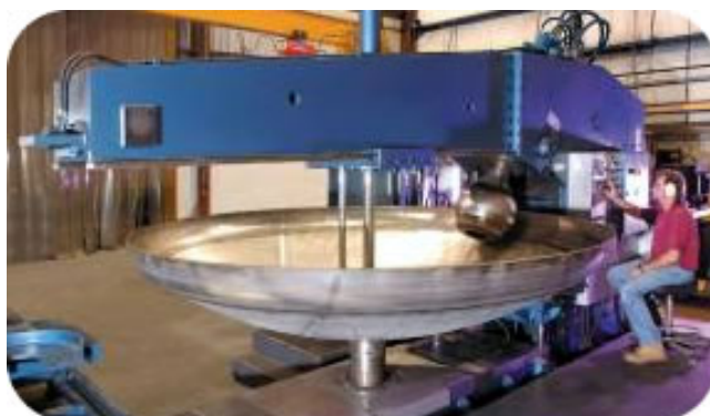
شکل ۶-۲ مراحل ساخت یک عدسی
